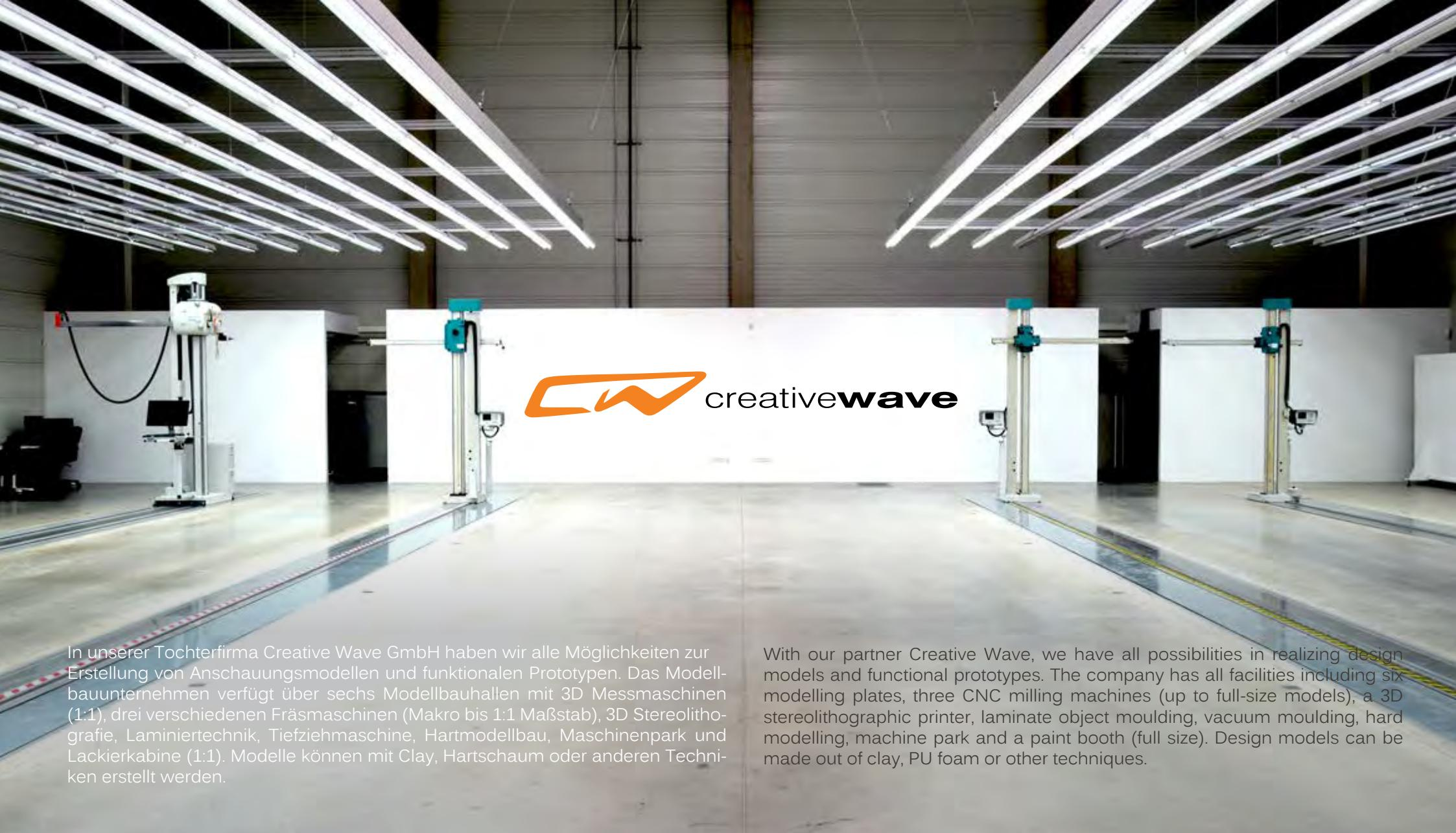
In unserer Tochterfirma Creative Wave GmbH haben wir alle Möglichkeiten zur Erstellung von Anschauungsmodellen und funktionalen Prototypen. Das Modellbauunternehmen verfügt über sechs Modellbauhallen mit 3D Messmaschinen (1:1), drei verschiedenen Fräsmaschinen (Makro bis 1:1 Maßstab), 3D Stereolithografie, Laminiertechnik, Tiefziehmaschine, Hartmodellbau, Maschinenpark und Lackierkabine (1:1). Modelle können mit Clay, Hartschaum oder anderen Techniken erstellt werden.
