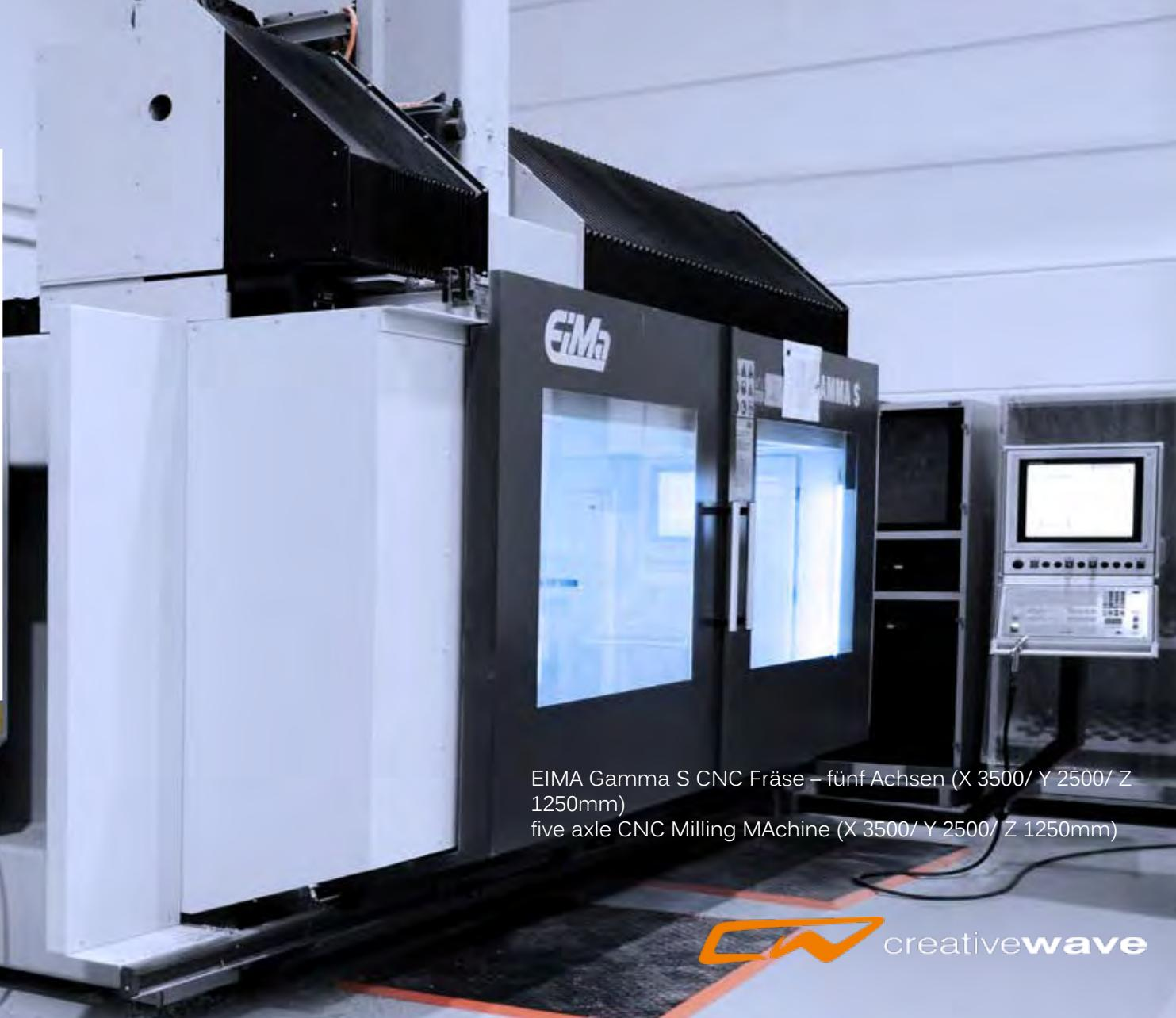
EIMA Gamma S CNC Fräse – fünf Achsen (X 3500/ Y 2500/ Z 1250mm)
